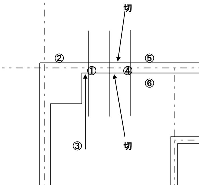
同じように他の外部建具を入れるように躯体を処理していきます。下記芯の①と②の間の中心を 800、③と④の間の中心を 1300、③と⑤の間の中心を 1700 空けるように「コーナー処理」します。
