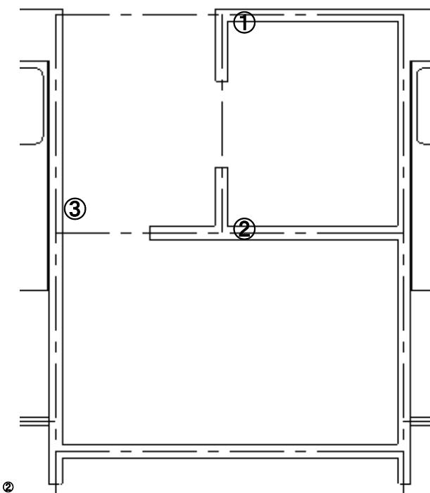
階層 0-3 の建具にして幅 1000mmの部品配置で、「引違い」の「引き違い2枚ヨコ」。線吸着を利用して配置し、右クリックから移動で 25
