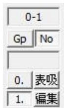
編集中以外の階層を淡色表示にして作図しやすくします。
