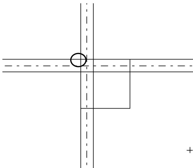
次に包絡処理をします。包絡とは、囲まれた部分を外形になぞっていき、重なる余分な線をなくす処理のことです。「ツール」「変形」「包絡」を選び、以下の図のように一点、二点クリックで囲んでください。包絡処理されます。
