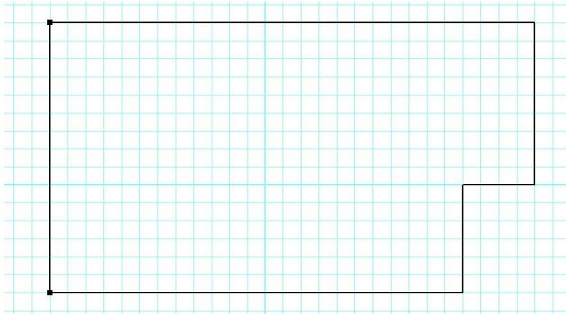
壁をもっと太く書きたくて、二重線多角形を使用する場合は、中の色を黒にして、進行左側距離を 0、右側を 100 にして作図します。始点と終点の間に空間ができるのではもう一つ二重線多角形を書いて埋め合わせます。
