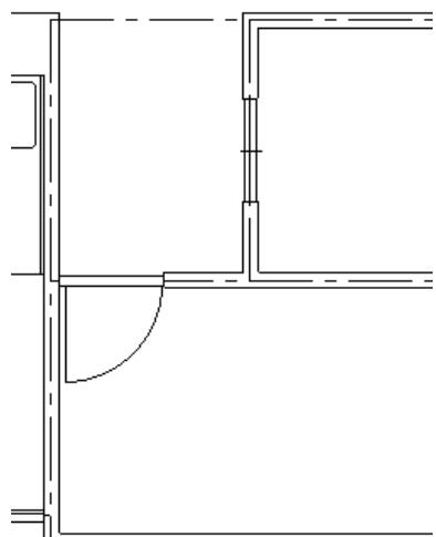
階層は 0-3 の建具のまま、部屋の 4 隅より 1100mm 内側に複線で線をひきます。
