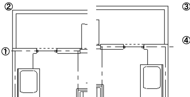
次はバルコニーです。廊下と同じように作成しますが、二重線を使います。「作図」の「二重線」で進行方向右側を0、左側を100にします。図面の左下の和室の下側の部分で、下記①をクリックし、同じ位置でshift+クリックで下方向に1125を入力して②を作成します。右
