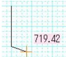
画面左の「アール作成」をクリックして、円弧の大きさを合わせて左クリックすると、1, 2点目の間が弧になります。
