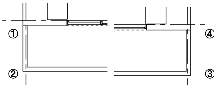
パルコニーの中に仕切り版を作成します。下記①と②を交点吸着で分割線を 2 分割で下記のような線をひきます。
