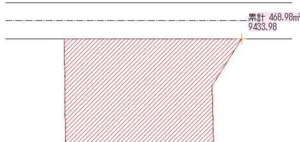
ツールの測定で「長さ累計」を選び、面積と同じように頂点をとっていくと、最後の点が最初の点までいったらダブルクリックすると、外周がでできます。
