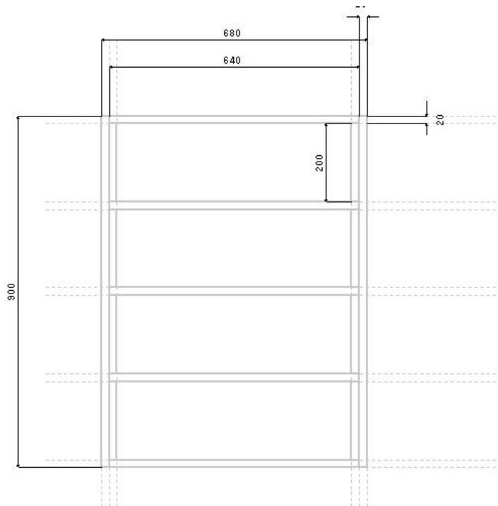
20mm の短い間は、その間の寸法線を削除し、「作図」「直線」
