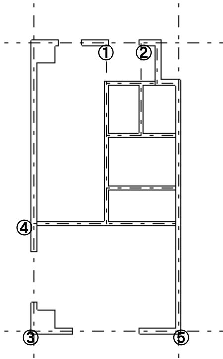
では③から⑤の部分を拡大し、階層0-3、階層名称を「建具」として、「部品配置」の「建具」「引違」の「引き違い2枚ヨコ」を配置し、右クリック「伸縮」で下記の幅に伸縮して、線吸着ONにして下図の位置に配置します。
