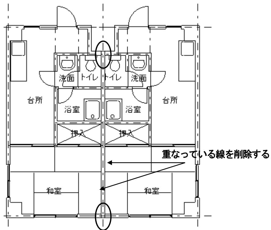
重なっている部分に文字「PS」を入れ、階層 0-6 にして階層名称を「仕上げ」として、芯上に  $800 \times 30$  の仕上げパネルを寸法指定四角形で配置します。
