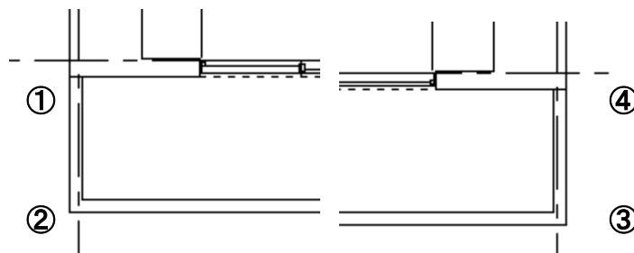
バルコニーの中に仕切り版を作成します。下記①と②を交点吸着で分割線を 2 分割で下記のような線をひきます。
