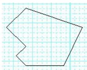
「ツール」「線化・線結合」「線結合で連続線、多角形化」を選びます。
