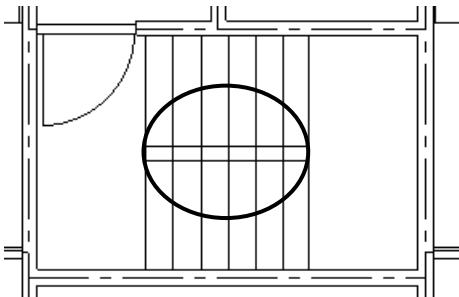
丸印の中5本を線切断し、線伸縮で以下のようにします。
