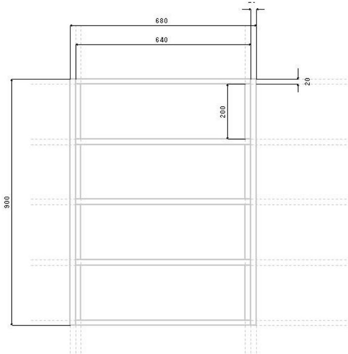
20mm の短い間は、その間の寸法線を削除し、「作図」「直線」で、「線の端点」を矢印にし、
