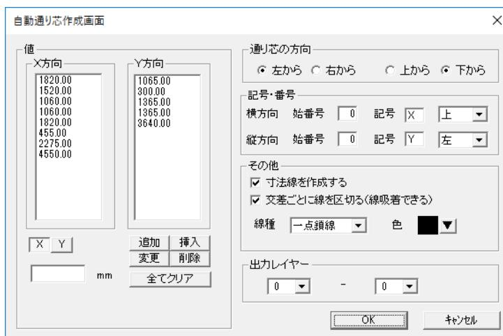
値…Xは横方向、Yは縦方向です。画面左下の入力欄に値を入力し、「追加」で追加します。リストの値をクリックして変更、削除、挿入
