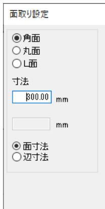
2・面取りしたい直線の上をクリックします。もう片方の線をクリックするとダイアログの内容で面取りされます。
