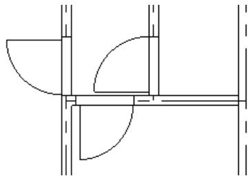
下向きのドアを選択し、移動で 50mm右に移動します。このように線吸着で位置を決めておいて、移動で目的の位置に動かす方法も便利です。
