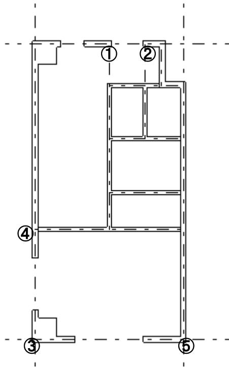
では③から⑤の部分を拡大し、レイヤー0-3、レイヤー名称を「建具」として、「部品配置」の「建具」「引違」の「引き違い2枚ヨコ」を配置し、右クリック「伸縮」で下記の幅に伸縮して、線吸着ONにして下図の位置に配置します。
