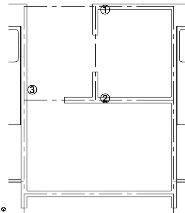
レイヤー0-3 の建具にして幅 1000mmの部品配置で、「引違い」の「引き違い2枚ヨコ」。線吸着を利用して配置し、右クリックから移動
