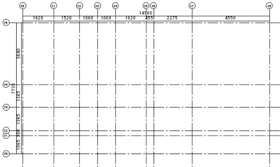
上記通り芯では線吸着で交点ごとに吸着しますが、操作スピードが遅くなったりしますので、通り芯で吸着を利用したい場合は、補助線グリッドを使うことをお勧めします。
