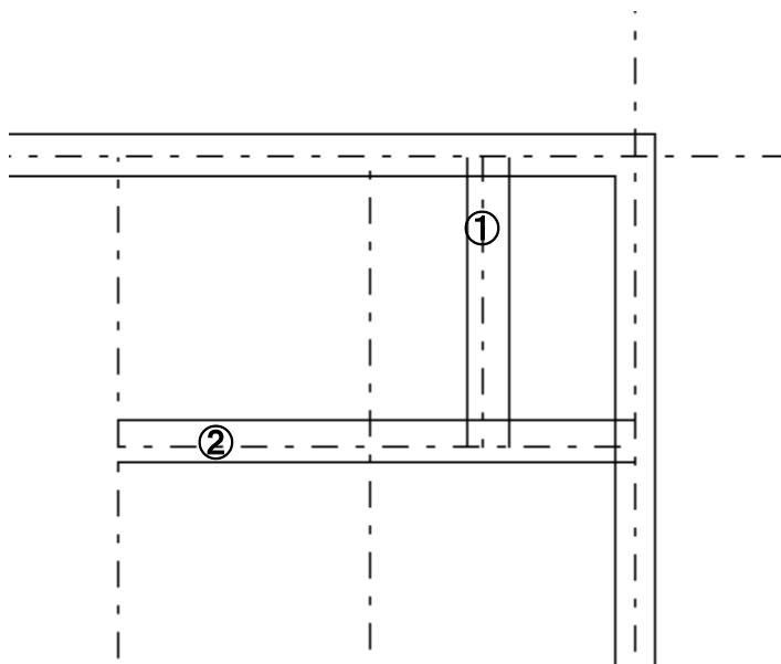
次に「ツール」「変形」「コーナー処理」で以下の図のようにします。「線伸縮」でもできますが、この場合「コーナー処理」の方が楽にできます。
